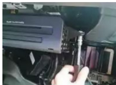
30. Entfernen Sie die Befestigungsschrauben der Original-CD
