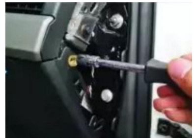
9. Entfernen Sie die Verkleidung und die Schrauben auf der rechten Seite des Beifahrer-Staufachs.
