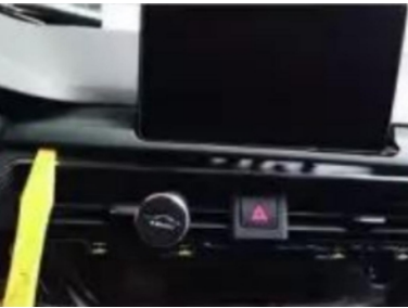
20. Entfernen Sie die Zierleiste unter dem Originalbildschirm
