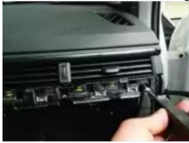
17. Entfernen Sie die Zierleiste unter dem Originalbildschirm
