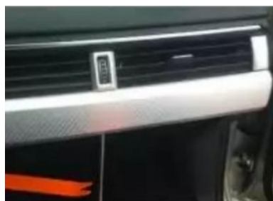
14. Entfernen Sie die Befestigungsschrauben der silbernen Verkleidung der Klimaanlage.
