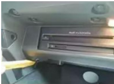
11. Öffnen Sie das Staufach und entfernen Sie die sechs Befestigungsschrauben.
