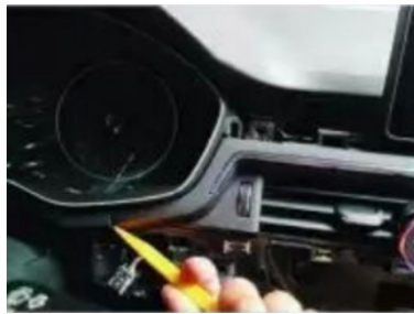
23. Hebeln Sie die kleine Blende unter Instrument
