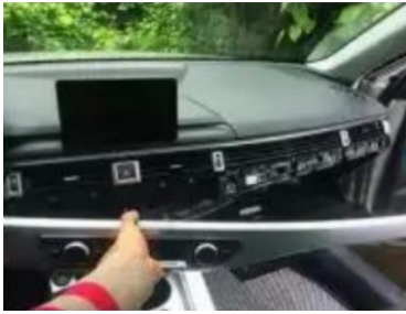
16. Entfernen Sie die silberne Klimaanlageblende
