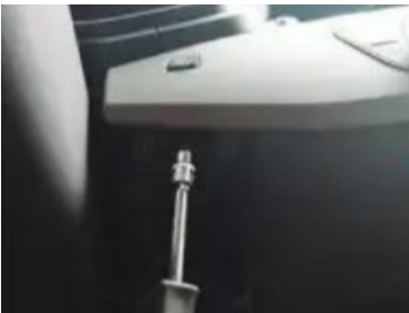
7. Entfernen Sie die Schrauben unter der silbernen Verkleidung der Mittelkonsole
