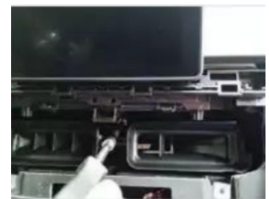
27. Entfernen Sie die Befestigungsschrauben des Originalbildschirms.
