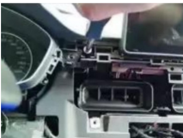
26. Entfernen Sie die Befestigungsschrauben des Originalbildschirms.
